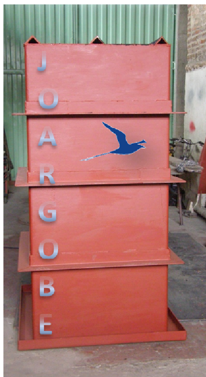
Fig.4 Tanque metálico 1/8" espesor en acero al carbón
