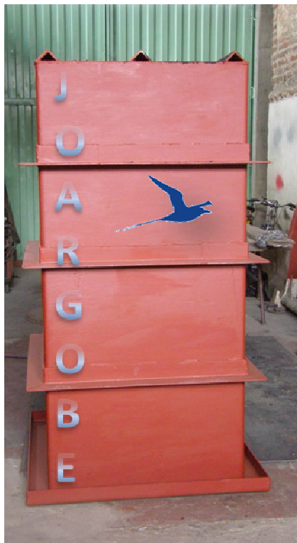
Fig.4 Tanque metálico 1/8" espesor en acero al carbón
